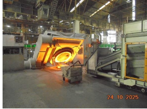
รูปที่ 1 ติดตั้ง Hood โรงงานเหล็กหล่อเสื้อสูบ
